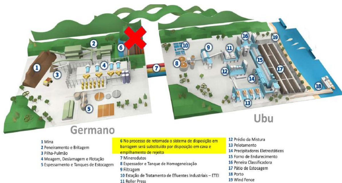
Figura 3: Apresentação esquemática das estruturas e infraestruturas do Complexo do Germano, desde a mina até o porto.
